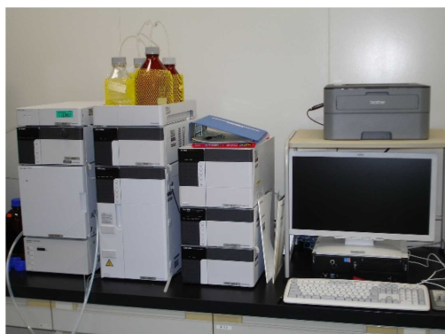
「液体クロマトグラフ」 液体の状態で分析を行うもの (分析例) 食品の糖組成、かび毒
