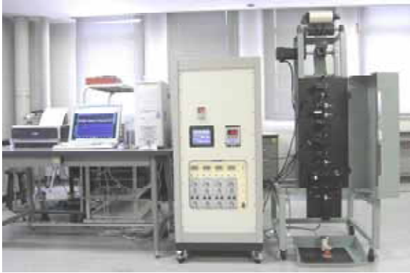
図1 日本生糸機械検査システム (縦型実用検査装置)
