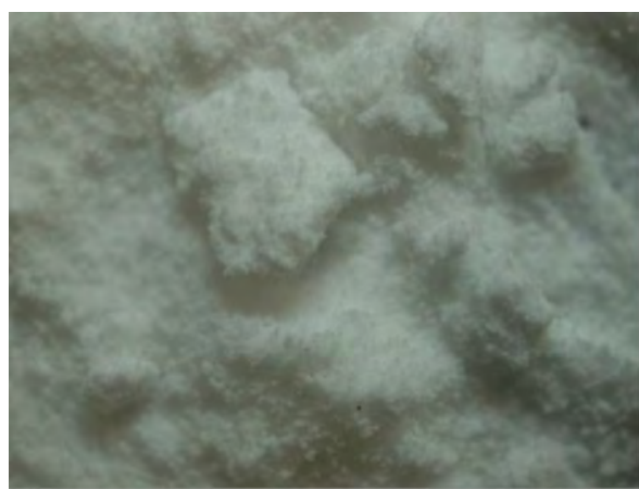
▲ 硝酸アンモニア(1), 実体顕微鏡(10倍)
