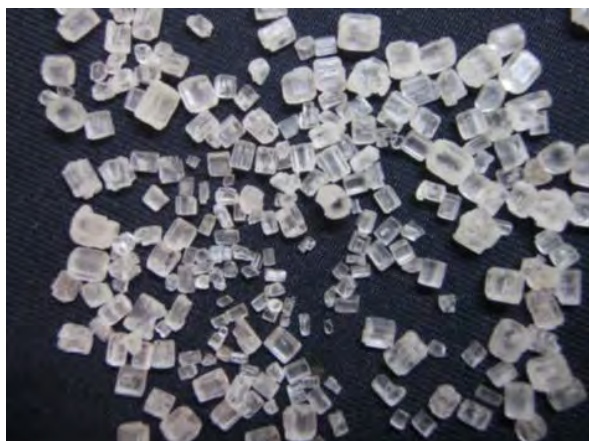
▲ 硫酸アンモニア(1), 現物 白色の斜方晶系の結晶である。
