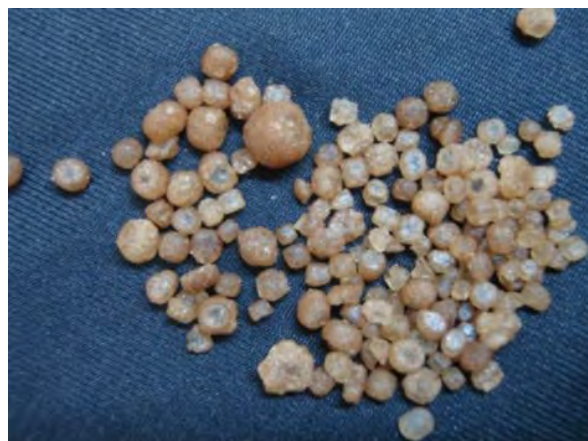
▲ 硫酸アンモニア(2), 現物 回収・副生硫安は着色するものもある。
