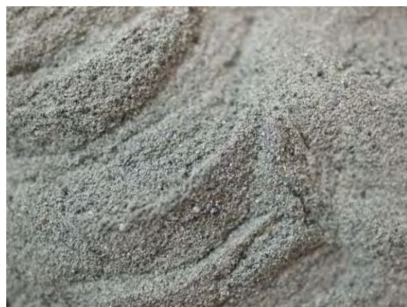
▲ 微粉炭燃焼灰(1), 実体顕微鏡(10倍)
