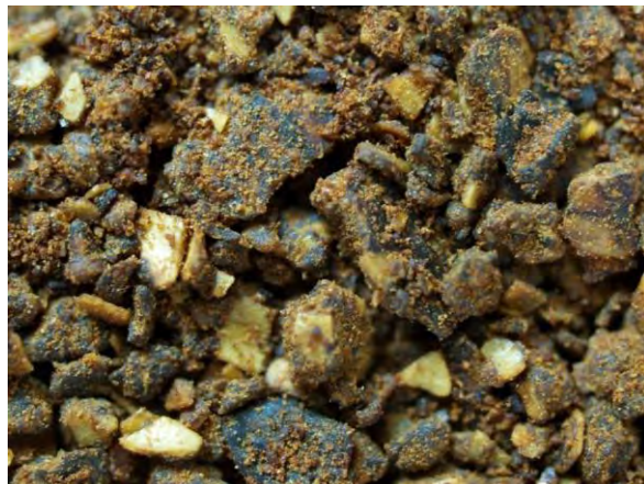
▲ 木の実油かす及びその粉末(2):ニームの種子から油を採ったかす, 実体顕微鏡(10倍)
