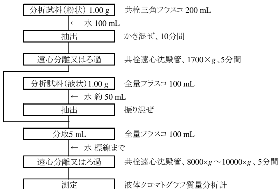
図 肥料中のスルファミン酸試験法フローシート
