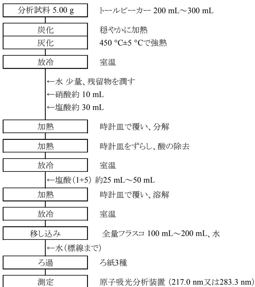
図 肥料中の鉛試験法フローシート
