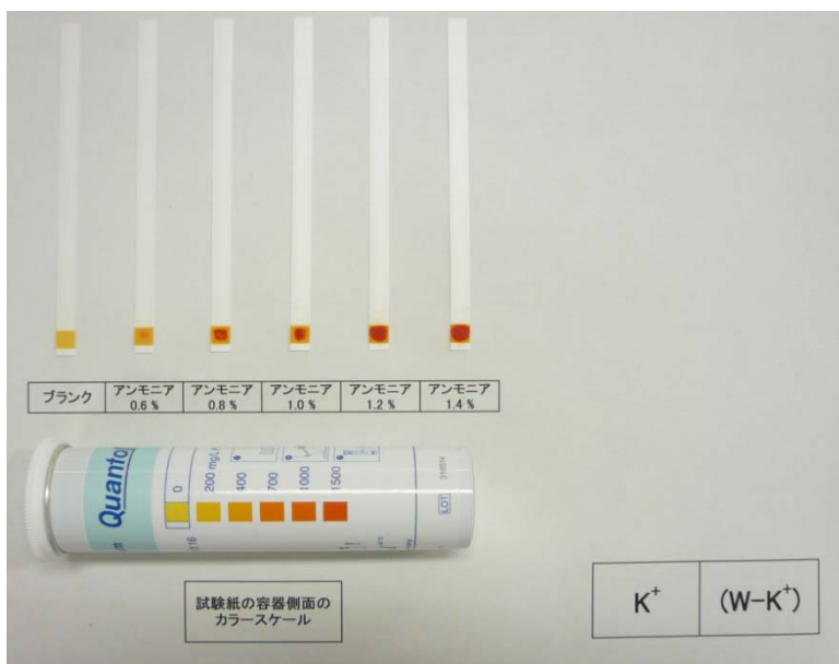
写真14 アンモニア水の偽陽性試験結果
