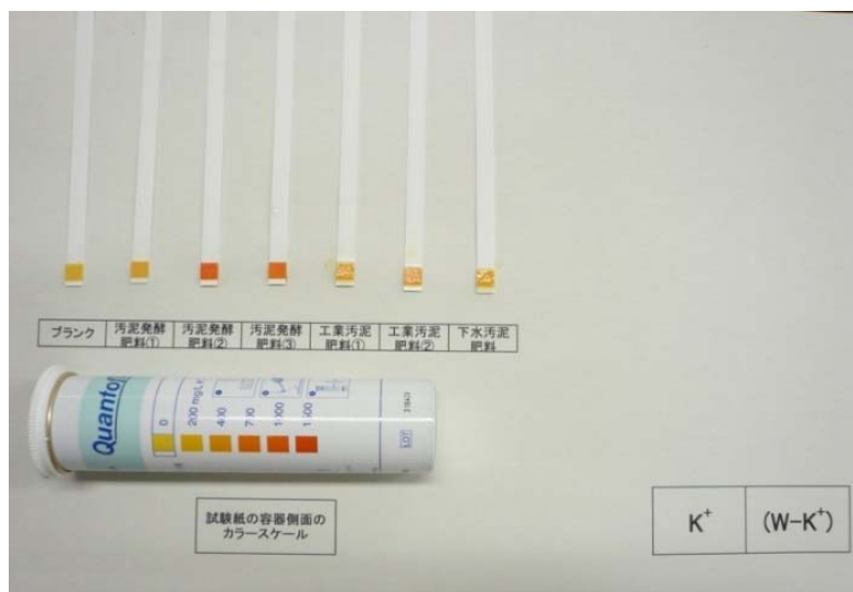
写真 33 流通肥料(汚泥肥料)の試験結果
