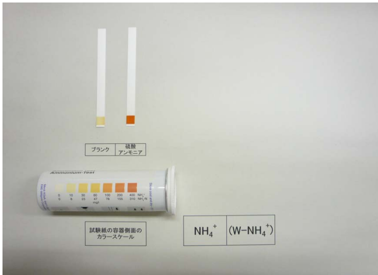
写真 45 未粉碎の硫酸アンモニア 3 粒の試験結果
