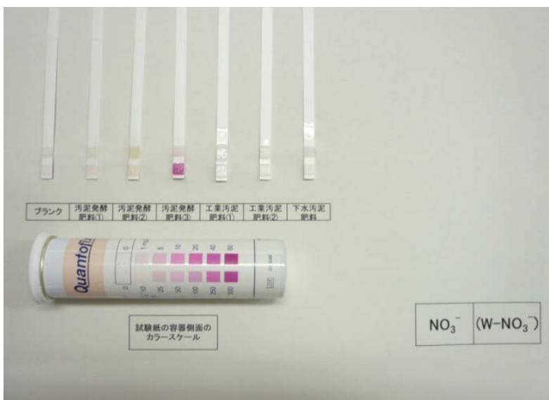
写真 30 流通肥料(汚泥肥料)の試験結果
