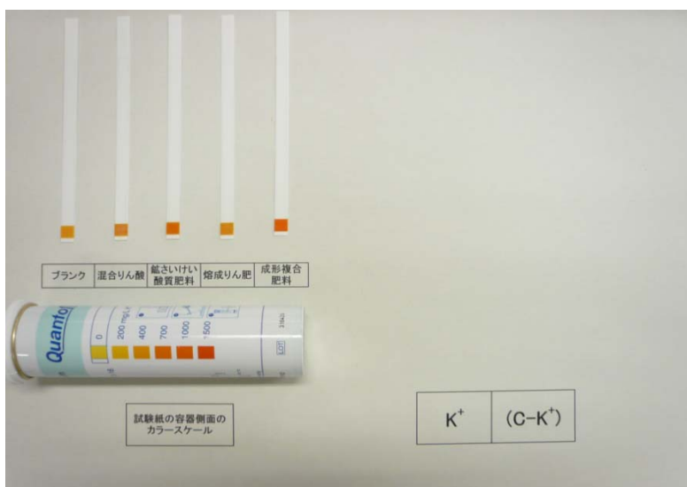
写真 26 流通肥料(普通肥料)の試験結果
