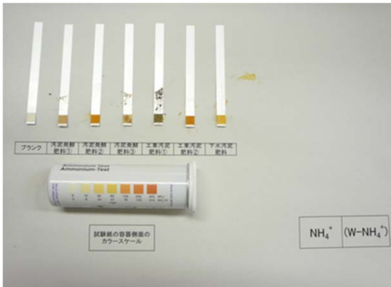
写真 40 ろ過していない溶液を用いた定性反応の例
