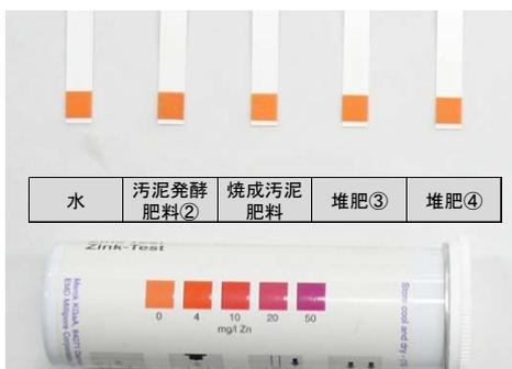
写真 22 流通肥料の試験結果
