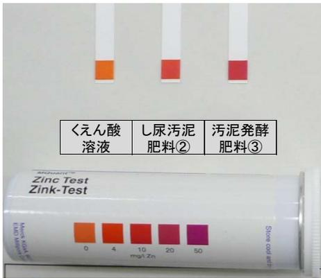
写真 40 流通肥料の試験結果
