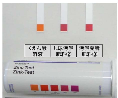
写真 39 流通肥料の試験結果
