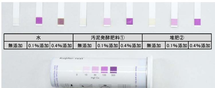
写真 3 硫酸銅(Ⅱ)五水和物の添加試験結果
