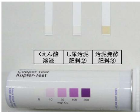
写真 32 流通肥料の試験結果
