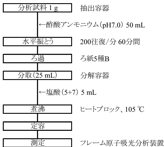
pH7.0酢安可溶カドミウム分析フロー
