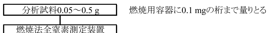
図1 燃焼法による肥料中の窒素全量試験法のフローシート
